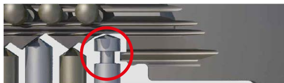
kontrolní jednotka Intop na klíči a v cylindrické vložce
